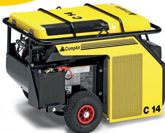
C10-12 bis C14, die schlagkräftige Alternative zum Elektrowerkzeug. Kompakter Kompressor – nur 165 kg Transportgewicht, mit einem Volumenstrom von 1,0 bis 1,4 m<sup>3</sup> / min bei 7 bis 12 bar. Ideal für verschiedenste Reparatur- und Installationsarbeiten.
